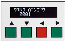
背面上部の液晶表示で必要な情報が表示されます。現在の受付番号を表示の他、設定スイッチで各種モードの設定ができます。
